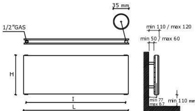
interasse del cent'c foro al muro min. 77 / max 87
