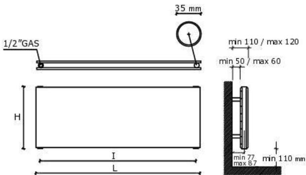
interasse del centro foro al muro min. 77 / max 87
